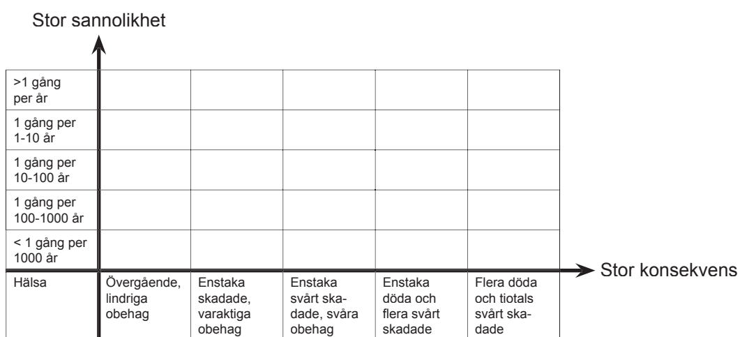
Figur 2. Exempel på riskmatris. Här kan olika olycksscenariers sannolikhet och konsekvens plottas för att jämföra de analyserade scenarierna samt värdera de olika identifierade scenariernas behov av skyddsåtgärder. Tre nivåer brukar identifieras: accepterade olyckskonsekvenser, konsekvenser som bör åtgärdas så långt möjligt samt icke acceptabla konsekvenser.
